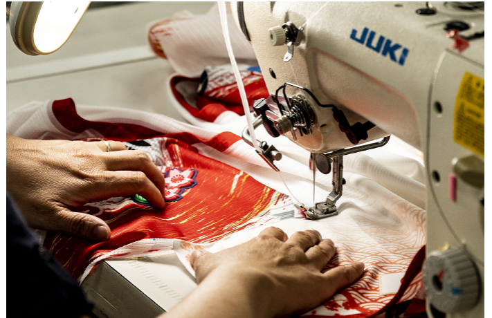
ゴールドウィン独自の技術であるSMART SEAM ® （スマートシーム）。縫い目をフラットにすることで、縫い目が肌にこすれるストレスを軽減します
