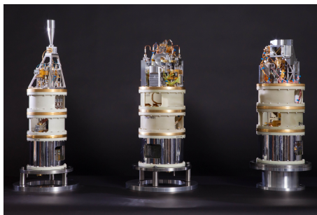
Obr. 4 — Vlevo: schéma jednoduššího regeneračního obvodu E. Armstronga. Vpravo: heterodynní přijímače dalekohledu ALMA pro pásma 4, 8 a 10 (787 až 950 GHz). U posledního by byly patrné (shora): zrcadlo M1, zrcadlo M2, trychtýř, drátová síťka, izolátory, směšovače SIS, zesilovače, 1. stupeň chlazený na 4 K, 2. na 15 K, tepelné mosty a radiátory, 3. na 115 K a 4. na 300 K.
