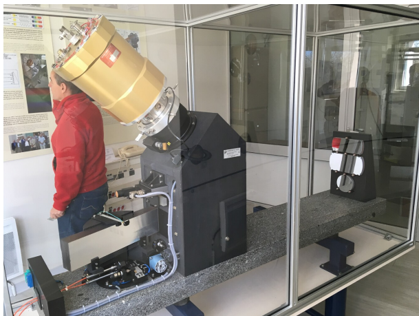
Obr. 17 — Echelletový spektrograf ELODIE. Jednotlivé součásti, postupně dle chodu paprsků: 2 optická vlákna (vlevo), štěrbinina, kolimátor M1 (vpravo), difrakční mřížka (vlevo), sférické zrcadlo M2 (vpravo), malé rovinné zrcadlo M4 (uprostřed), sférické zrcadlo M3 (vpravo), hranol (uprostřed, skryt), čočkový objektiv kamery, CCD a chlazení.
