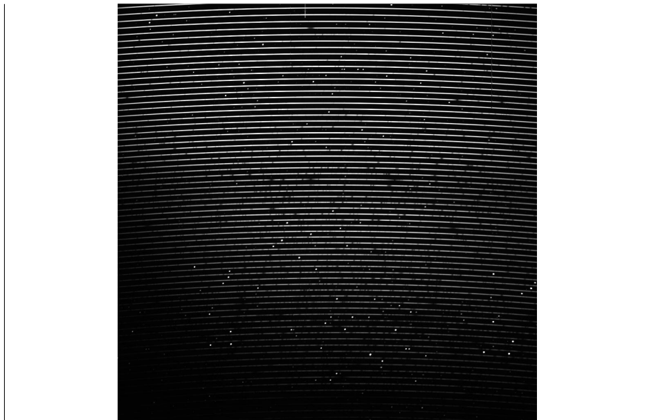
Obr. 18 — Echelletové spektrum 51 Peg. Vlnová délka \lambda roste postupně zleva doprava a po jednotlivých rádech spektra shora dolů. Pod absorpčním spektrem hvězdy je zaznamenáno emisní spektrum kalibrační výbojky Th–Ar.
