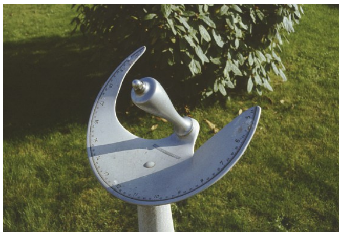
Obr. 71 — Sluneční hodiny v Heidelbergu, v prostorách Max Planck Institut für Physik, mají tlustý ukazatel tvarovaný podle analemy, aby bylo na číselníku možné číst středoevropský čas. Při pohledu od severu je třeba sledovat levou hranu stínu. Pro tyto hodiny existují dva různé výměnné ukazatele: jeden je určen pro zimu a jaro (na obrázku) a druhý pro léto a podzím. Viz též [135]. Foto Martin Šolc (2004).
