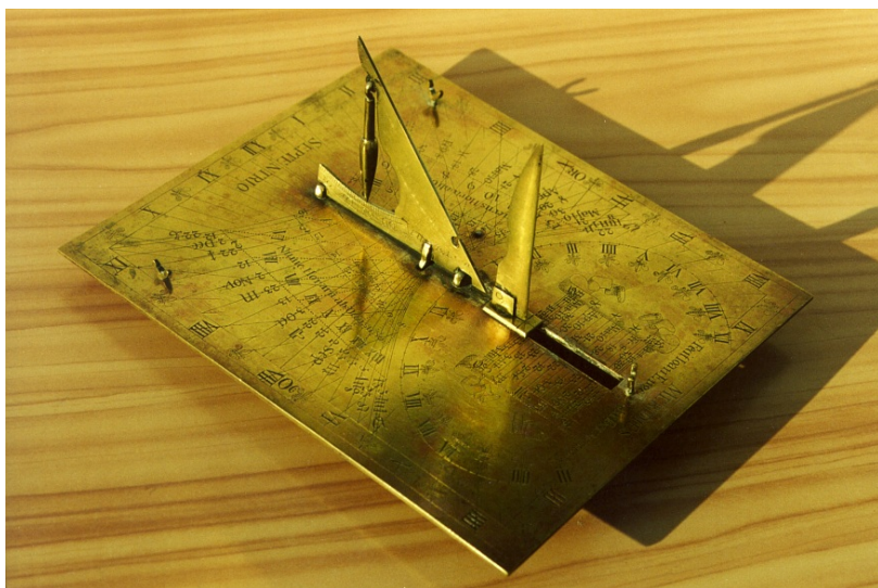
Obr. 107 — Mosazné stolní sluneční hodiny od Jana Engelbrechta, vystavené na Štefánikově hvězdárně, v Praze na Petříně. Jedná se o kombinaci vodorovných hodin s polosem a analematických hodin s kolmým pohyblivým ukazatelem. Při takovém uspořádání není nutný pro orientaci přenosných hodin kompas — stačí je pouze otočit tak, aby oba číselníky ukazovaly stejný časový údaj. Foto Martin Šolc (2003).
