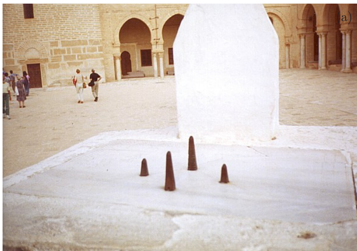
Obr. 19 — Vodorovné sluneční hodiny v mešitě v Kairouanu v Tunisku. Jedná se o poměrně složité hodiny vybavené čtyřmi kolnými ukazateli (označme je podle světových stran S, J, V, Z). Stín severního gnómonu ukazuje na obvodu číselníku PMSČ, uvnitř kalendária (sestavujícího ze dvou hyperbol a jedné přímky) babylonský a italský čas a na křivce označené N_{Asr} lze číst začátek modlitby Asr (viz obr. 18). Jižní gnómon ukazuje začátek modlitby Dhor (na křivce S_{dhor} ), východní, resp. západní gnómon ukazuje čas uplynulý od úsvitu, resp. zbývající do setmění, a to na křivkách označených O_3 , O_4 , resp. E_3 , E_4 . (Zde se nemyslí východ/západ Slunce, ale začátek/konec astronomického soumraku.) V dolní části hodin je vyznačen azimut muslimského poutního města Mekky a nápis dokumentující celkovou rekonstrukci a přepočítání hodin v roce 1289 Hidžry (tj. rok 1837 podle řehořského kalendáře). V současnosti jsou již sluneční hodiny značně poškozeny povětrnostními vlivy — číselník je nezřetelný a gnómony jsou zkráceny asi o 0,5 cm. (a) Foto Katarína Brožová (2001). Obrázky (b), (c) převzaty z [66].
