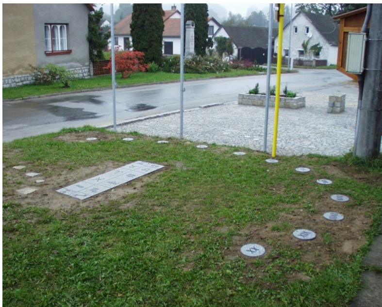
Obr. 78 — Zemní analematické hodiny v Zahrádkách (JH 25), před obecním úřadem. Na datových značkách jsou znamenají zvířetníku, hodinové kameny jsou s římskými orlojními číslicemi (od IX do XX). Foto Jan Zeman (2002).
