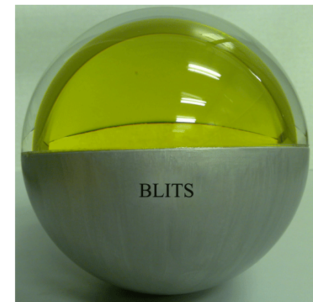
Spherical satellite «BLITS» weighing 7.5 kg, Ø 170 mm
