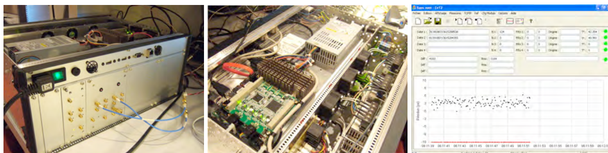
Figure 6-15 : Kit T2L2. De gauche à droite : Face arrière avec les modules de métrologie et les entrées sorties réseaux, USB, ... ; Vue de dessus avec alimentation et PC embarqué ; Logiciel embarqué
