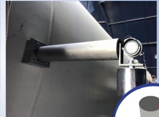
Prismes pendulaires Mesure de l'axe d'élévation
