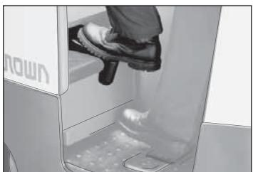
Pise el pedal del freno central del pedestal con el pie izquierdo. Esta operación permite que el sistema electrónico de la carretilla compruebe si el pedal del freno funciona antes de conducir la carretilla.
