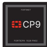
メイン CPU のコプロセッサとして機能するコンテンツプロセッサ (CP9) は、多くのリソースを必要とする処理の負荷を軽減すると同時にコンテンツのインスペクションを強化して、セキュリティ機能の動作を加速します。
