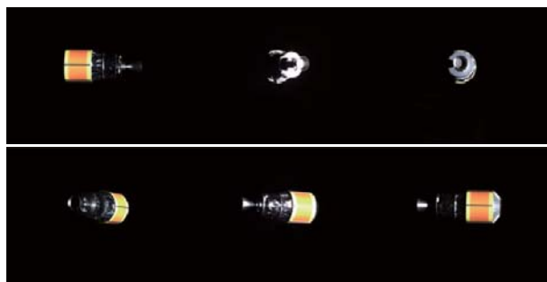
図4 光学シミュレータで撮像した回転運動をする模擬H2Aロケット上段
