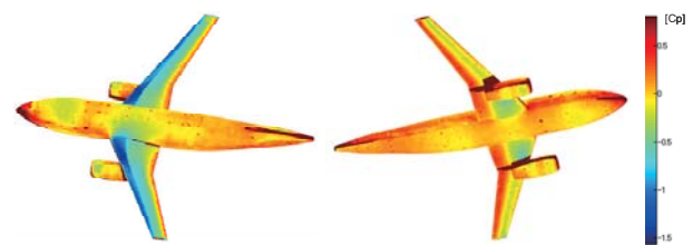
図 5 感圧塗料による DLR-F6 模型の表面圧力計測 (M=0.75, \alpha=1\text{deg} , 上面(左)および下面(右))
