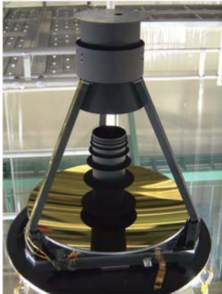
図 2 「あかり」望遠鏡 金蒸着面が見えている のが SiC 製主鏡
