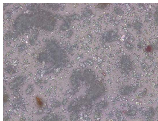
図5 アルミ蒸着ポリイミドに付着したシミュラント
