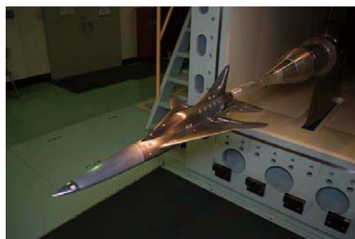
図 7 静粛超音速研究機によるラフネス高さ評価
