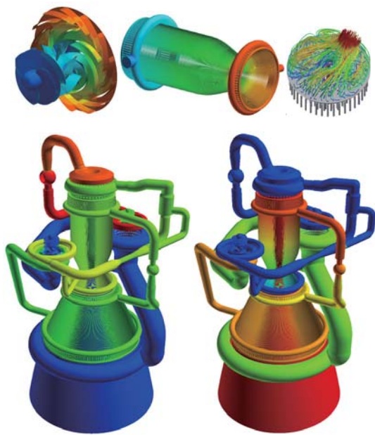
図2 主要コンポーネント解析結果(上)とエンジン全体圧力(下左)、温度(下右)分布
