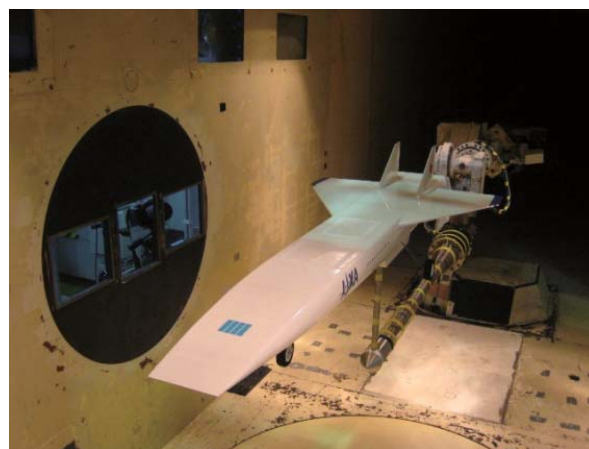
図6 制御特性試験（風速30m/s、六分力測定）
