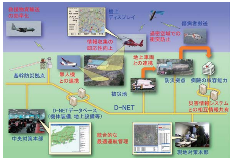
図2 「災害救援航空機情報共有ネットワーク(D-NET)」の全体概念図
