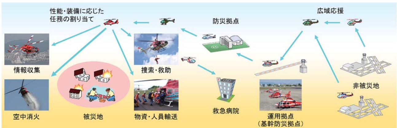
図1 大規模災害時のヘリコプタ運航の流れ
