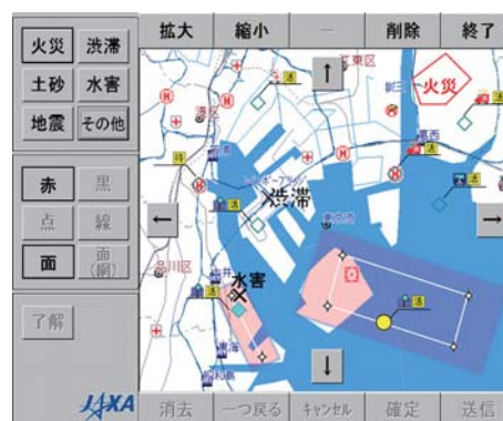
図 8 D-NET 機上ディスプレイ表示例(災害情報入力画面)
