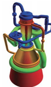
図1 エンジン全体の温度分布（青は温度が低く、緑、オレンジ、赤の順に高くなる）
