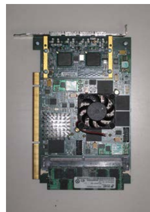
図3 重ね合わせ法専用FPGA ボード
