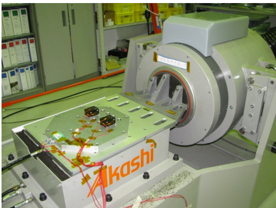
図 3 機器の振動試験
