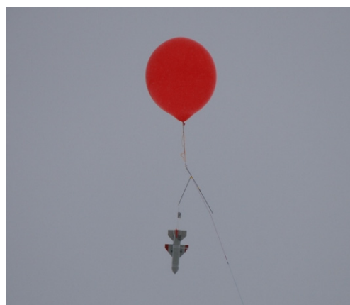
図7 金沢大学の小型実験機と飛行実験の様子 (実験機の全長0.8m、質量約600g)
