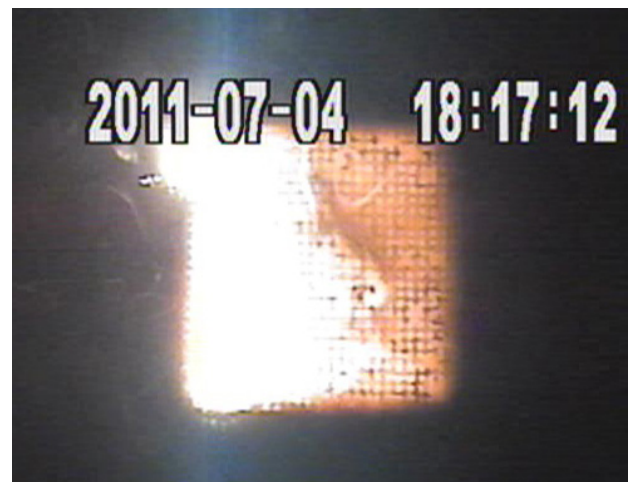
図6 加熱中の試験片の様子 (レーザーが照射されているところが白熱している)
