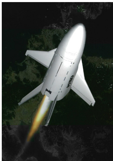
図 8 有翼ロケット実験機概念図 (全長 9.1m, 打上げ時質量約 5.2ton)
