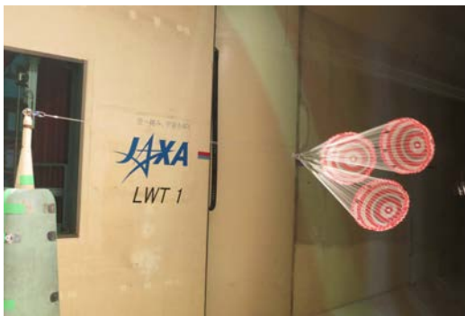
図10 \phi 1\text{m} のリングセイル傘特性評価風洞試験
