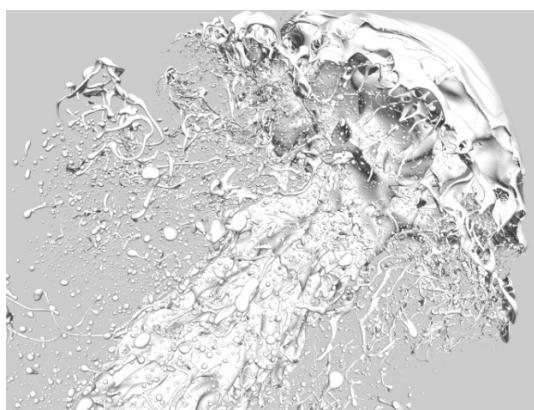
図5 噴霧先頭部付近の微粒化の様子
