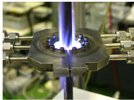
図6 耐熱材料の熱応力サイクル試験
