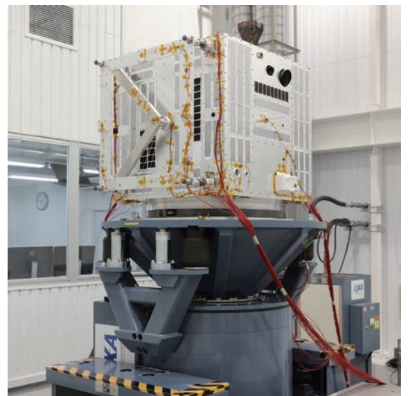
RAPIS-1 振動試験 RAPIS-1 Vibration Test
