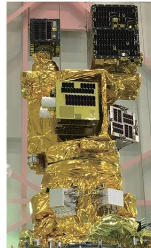
複数衛星搭載構造
