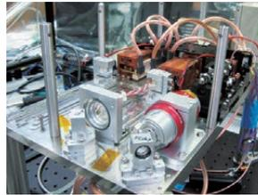
Qswパルスレーザ (与圧筐体封入前の振動試験モデル)
