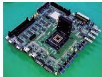
試作品の試験ボード搭載状態
