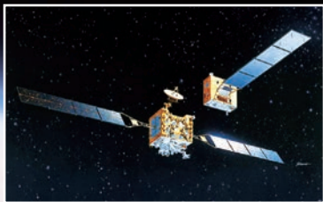
ETS-VII 技術試験衛星VII型「おりひめ・ひこぼし」 軌道上自動ランデブ・ドッキング技術の 試験検証
