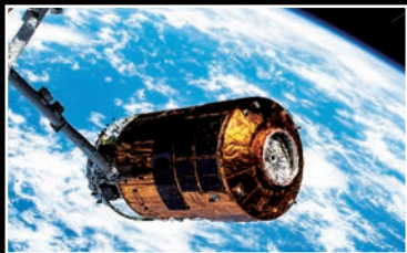
HTV 宇宙ステーション補給機「こうのとり」 ISSターゲットへの自動ランデブ技術 の試験検証
