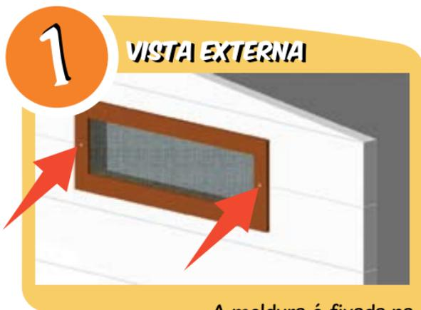
A moldura é fixada na peça complementar interna por parafusamento
