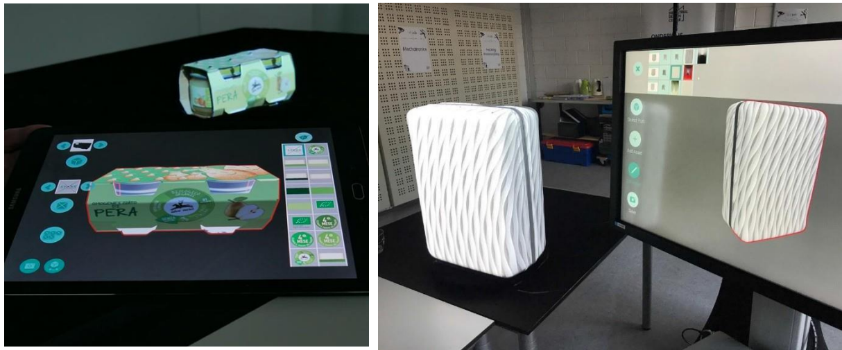
Figure 1a et 1b. Projections d'images virtuelles sur des prototypes physiques via la plateforme SPARK sur tablette et ordinateur
