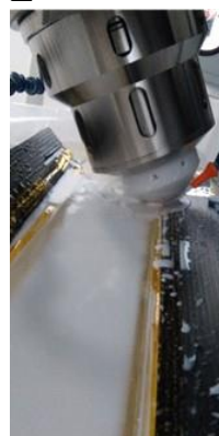
C) Prototipo di ottica a shell sottile monolitica in vetro per raggi X (progetto Tecnologie del Vetro per ottiche X finanziato da ASI). D) Specchio collimatore per raggi X sviluppato per la facility BEaTriX (finanziata da ESA, AHEAD, ASI e INAF). E, F) Lavorazione dello specchio collimatore per la seconda linea di BEaTriX in corso di realizzazione.
