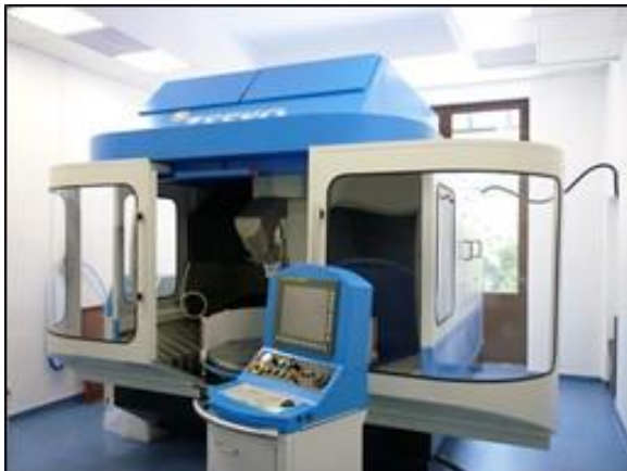
A) Macchina Zeeko IRP1200. B) Lavorazione di specchio asferico (progetto COSMOS, finanziato da Cariplo e Regione Lombardia).
