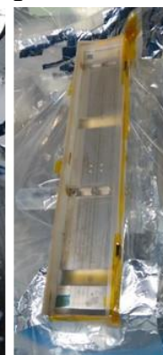
C) Prototipo di ottica a shell sottile monolitica in vetro per raggi X (progetto Tecnologie del Vetro per ottiche X finanziato da ASI). D) Specchio collimatore per raggi X sviluppato per la facility BEaTriX (finanziata da ESA, AHEAD, ASI e INAF). E, F) Lavorazione dello specchio collimatore per la seconda linea di BEaTriX in corso di realizzazione.
