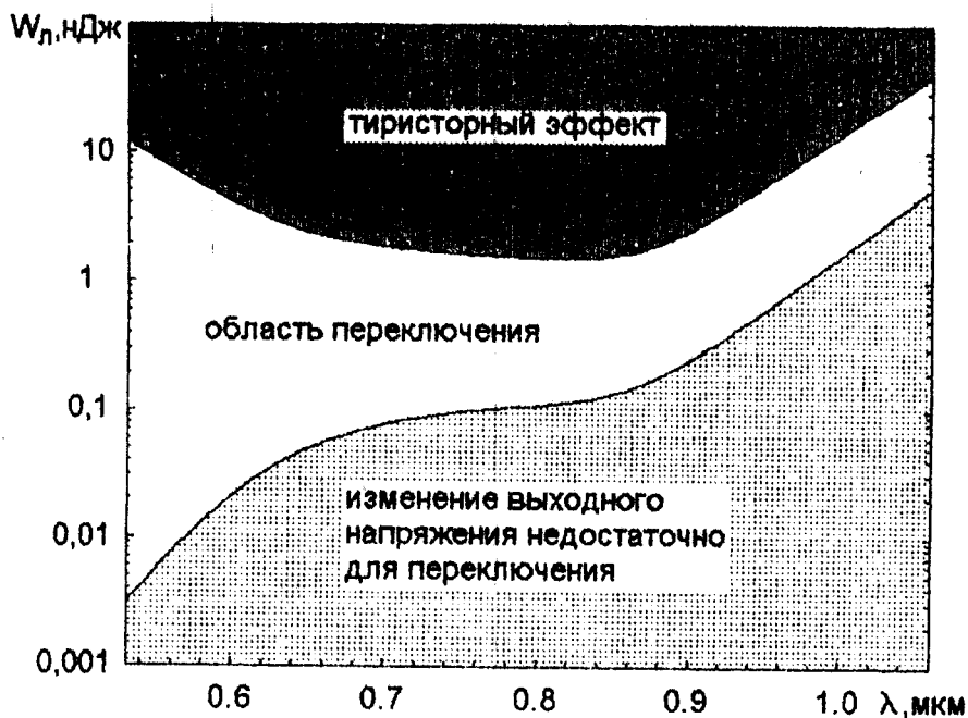
Рис.2. Зависимости режима работы КМОП-инвертора в состоянии лог. «0» от длины волны ЛИ и энергии импульса излучения
