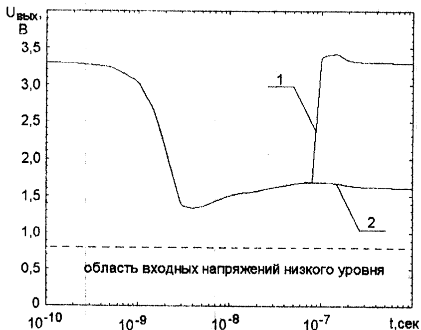
Рис.3. Временные зависимости выходного напряжения КМОП-инвертора в состоянии лог. «1» при воздействии импульса ЛИ с длиной волны 0,53 мкм и с энергиями 0,35 нДж (1) и 0,36 нДж (2)
