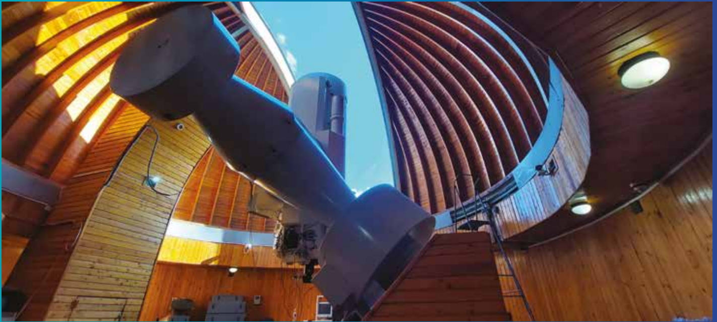
Основной инструмент Симеизской обсерватории Цейсс-1000 / The main instrument of the Simeiz Observatory Zeiss-1000
