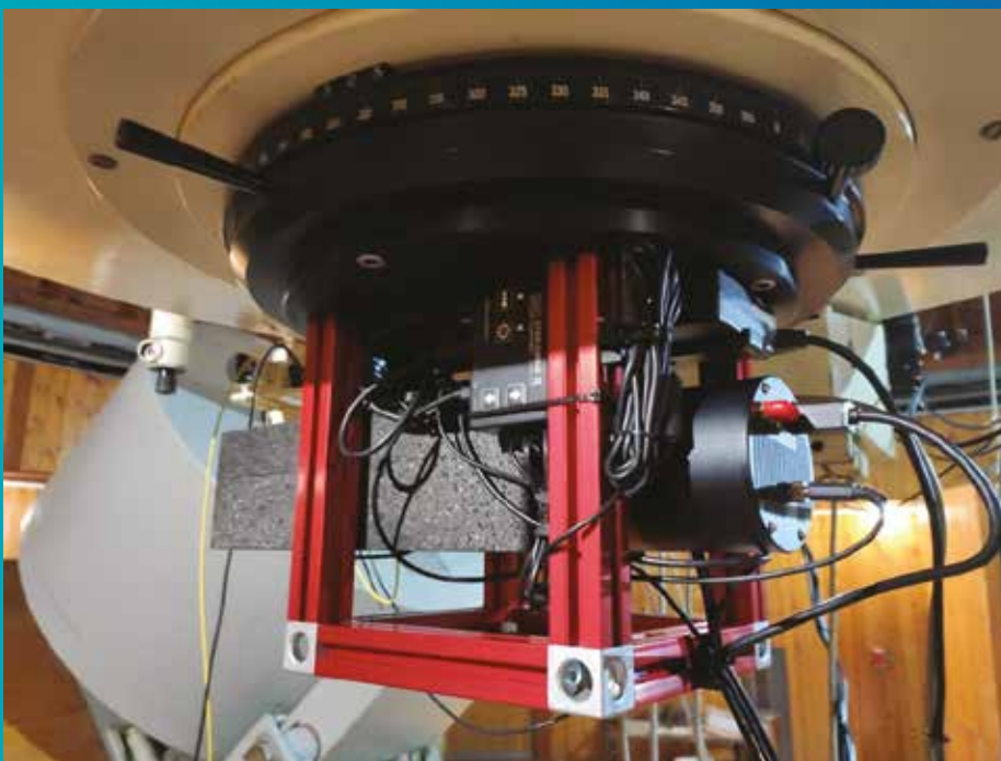
Компактный спектрограф Baader BACHES среднего разрешения, установленный на телескопе Zeiss-1000 Симеизской обсерватории / A compact medium resolution spectrograph Baader BACHES installed on the Zeiss-1000 telescope
