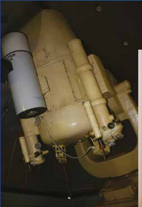
Камера ВАУ, на протяжении многих десятилетий использовавшаяся для наблюдений спутников / VAU camera that has been used over decades to observe satellites
