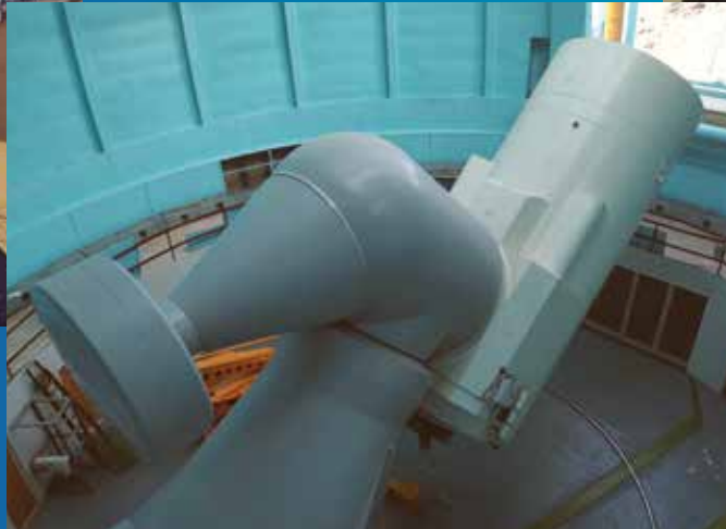
Большой горизонтальный солнечный телескоп АЦУ-26 с пятикамерным спектрографом / The large horizontal solar telescope ACU-26 with a 5-camera spectrograph
