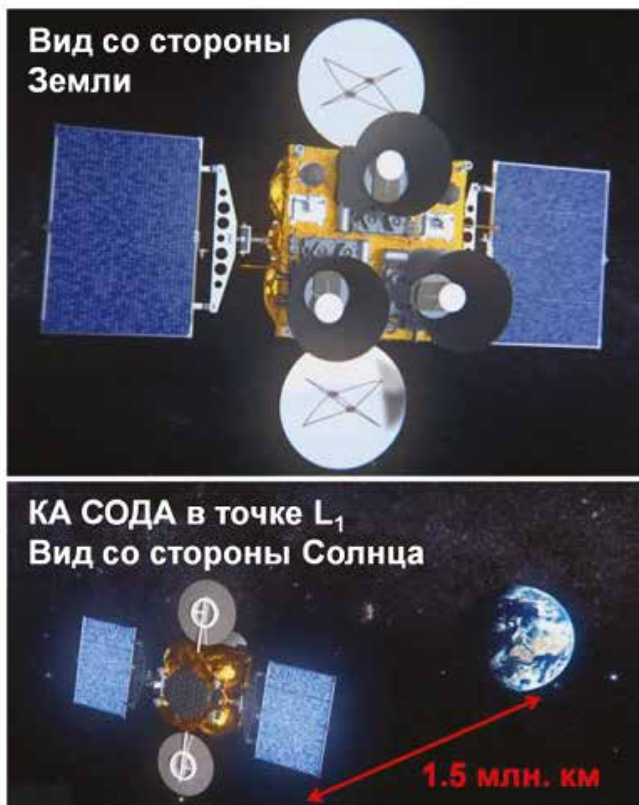
Концептуальный вид КА СОДА с тремя телескопами / A schematic view of a SODA spacecraft with three telescopes
