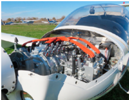
飛行試験用の機体に搭載された電動推進システム
