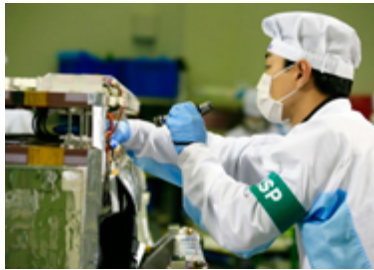
振動試験後の点検作業の様子
