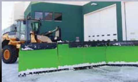
23-FT CUPPING RAMP PLOW: BIL
