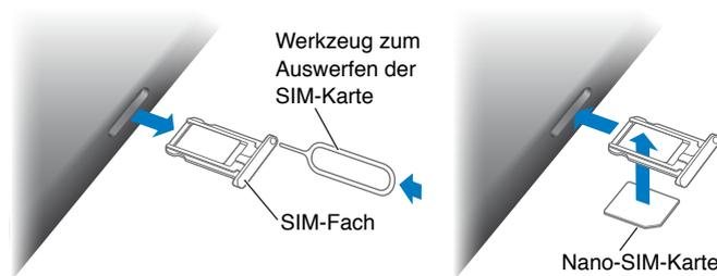
**Öffnen des SIM-Fachs:** Führen Sie das Auswerfwerkzeug gerade in das Loch des SIM-Kartenfachs ein und drücken Sie so lange, bis das Fach herauspringt. Ziehen Sie das SIM-Fach heraus, um die SIM-Karte zu installieren bzw. auszutauschen. Wenn Sie das Werkzeug zum Auswerfen der SIM-Karte nicht zur Hand haben, können Sie eine aufgebogene Büroklammer verwenden.
