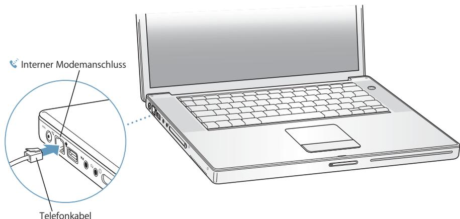
Vergewissern Sie sich, dass Sie das interne Modem an eine analoge Telefonleitung anschließen. Analoge Telefonleitungen werden normalerweise in Privathaushalten verwendet. Das Modem funktioniert nicht in Verbindung mit einer digitalen Telefonleitung.
