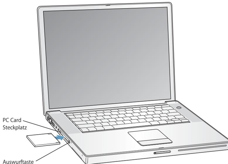
**Wichtig:** Die Apple AirPort Extreme Karte ist in einem Steckplatz im Inneren des Computers installiert. Im Gegensatz zu Karten für die drahtlose Kommunikation von Drittanbietern passt diese nicht in den PC Card Steckplatz. Die AirPort Extreme Karte funktioniert nicht, wenn sie im PC Card Steckplatz installiert wird. Dies kann zudem Fehlfunktionen des Computers verursachen.
