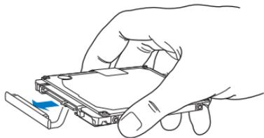
El conector está unido a un cable y permanece en el compartimento del disco rígido.
