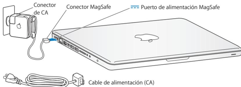
Para ampliar el alcance del adaptador de corriente, reemplace el conector de CA por el cable de corriente alterna. Primero tire del conector de CA para extraerlo del adaptador y, después, conecte el cable de corriente alterna incluido, asegurándose de que encaja firmemente.
