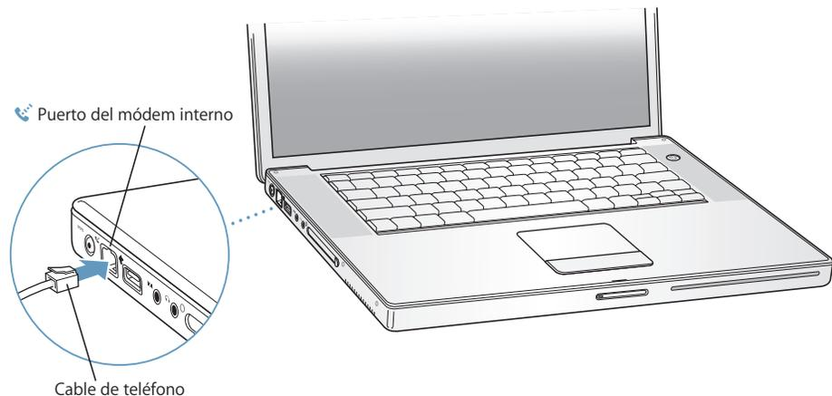
Asegúrese de que conecta el módem interno a una línea telefónica analógica, la que suele usarse en las casas. El módem no funcionará con una línea telefónica digital.
