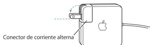
**Importante:** Asegúrese de que las dos clavijas del conector de corriente alterna quedan perfectamente acopladas antes de enchufar el adaptador.
