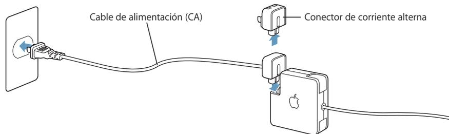
**Advertencia:** Compruebe que el adaptador de corriente esté perfectamente ensamblado antes de conectarlo a una toma de corriente. Si está utilizando el conector de corriente alterna con el adaptador de corriente, asegúrese de que las dos clavijas quedan perfectamente acopladas antes de enchufar el adaptador.
