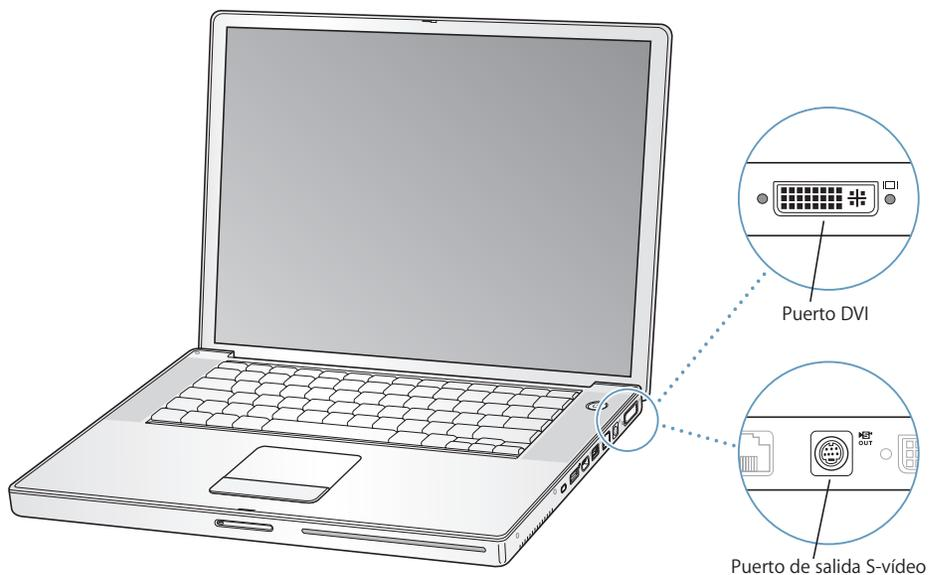
Al conectar un monitor externo o un televisor, puede elegir entre visualizar la misma imagen en la pantalla interna y el monitor externo (*duplicado de vídeo*) o bien utilizar el monitor externo para ampliar el tamaño del escritorio del Mac OS (*modalidad de pantalla dual*). Como valor predeterminado, el PowerBook arranca en modalidad de pantalla dual. Pulse la tecla F7 (⌘) para alternar entre las modalidades de duplicado de vídeo y de pantalla dual.
