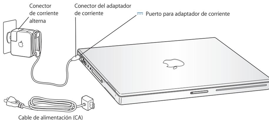
Si lo desea, puede utilizar el cable de corriente alterna para ampliar el alcance del adaptador de corriente. Consulte "Uso del adaptador de corriente" en la página 23.
