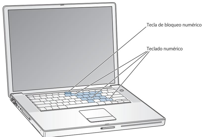
Para utilizarlo, pulse la tecla del teclado numérico. Se encenderá una luz verde en esta tecla para indicar que el teclado numérico está activo. Al terminar, púselo de nuevo para desactivarlo.
