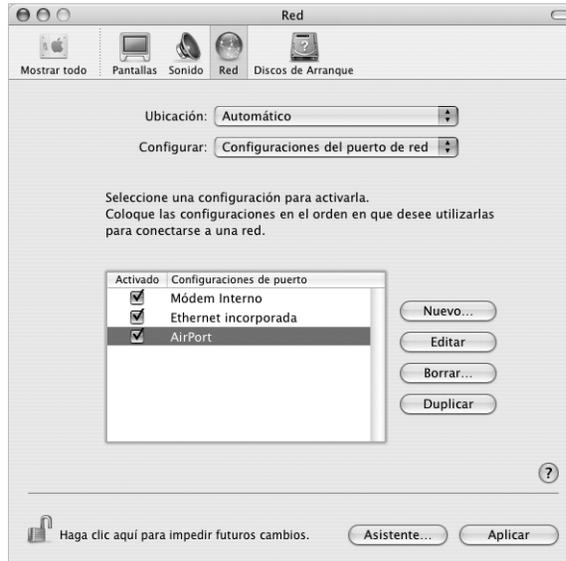
A continuación, siga las instrucciones para configurar la red manualmente o mediante DHCP, según lo que le indique su proveedor de acceso a Internet o el administrador de red. Si configura la red usted mismo, probablemente le resultará más sencilla la configuración mediante DHCP, pues el servidor se encargará de asignar las direcciones IP de forma automática.
