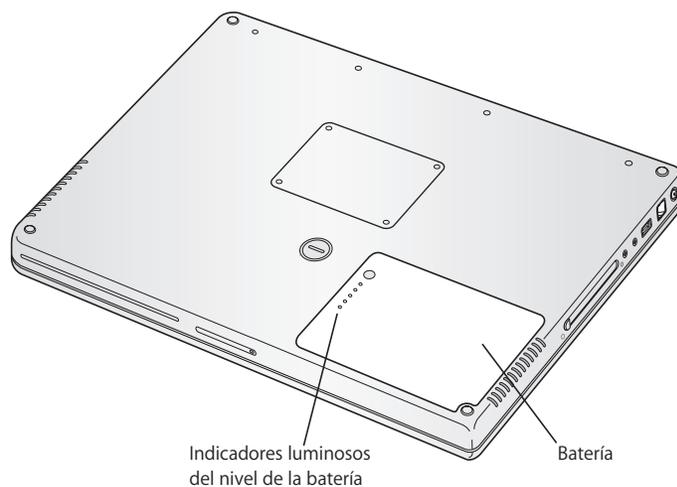
Si ha configurado el icono de batería de la barra de menús del Finder para que muestre el porcentaje de carga, quizás advierta que la batería no mantiene una carga completa del 100% cuando el adaptador de corriente está conectado al ordenador. Cuando el nivel de carga de la batería baja por debajo del 95%, volverá a cargarse al 100%. De este modo se preserva la vida útil de la batería, pues el proceso de carga no se activa y desactiva una y otra vez.
