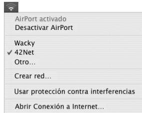
Si en la lista no aparece ninguna red AirPort, compruebe o cambie sus ajustes mediante el Asistente Configuración AirPort o a través del panel Red de Preferencias del Sistema.
