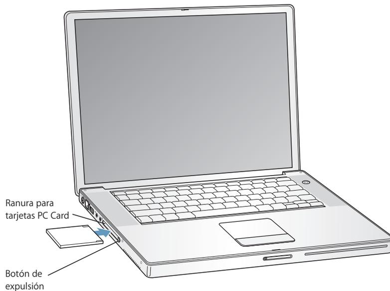
**Importante:** La tarjeta AirPort Extreme de Apple se instala en una ranura interna especial del ordenador. Este tipo de tarjetas no puede instalarse en la ranura para tarjetas PC Card, a diferencia de lo que ocurre con las tarjetas inalámbricas de otros fabricantes. En caso de instalarla en esa ranura, ni la tarjeta AirPort Extreme ni el ordenador funcionarán correctamente.
