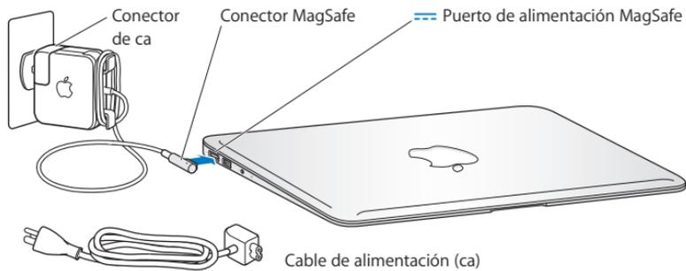
Para aumentar el alcance del adaptador de corriente, reemplace el conector de ca por el cable de alimentación incluido. Para ello, tire del conector de ca hacia arriba para separarlo del adaptador y, a continuación, conecte el cable de alimentación al adaptador asegurándose de que queda bien fijado. Enchufe el otro extremo a una toma de corriente.
