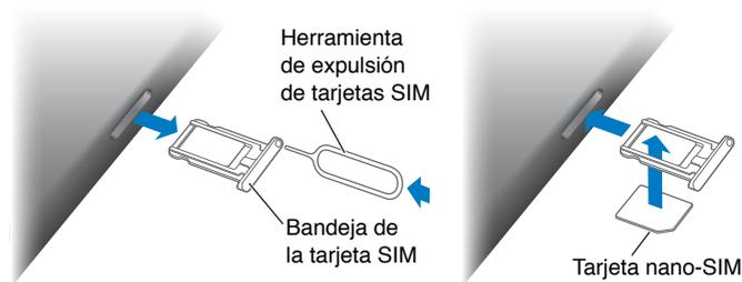
**Abrir la bandeja SIM:** Inserte una herramienta de expulsión de SIM en el orificio de la bandeja SIM y presione con firmeza con ella hasta que la bandeja salga. Extraiga la bandeja SIM para instalar o sustituir la tarjeta SIM. Si no dispone de herramienta de expulsión de tarjetas SIM, pruebe con el extremo de un clip pequeño.
