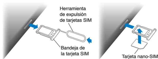
**Abrir la bandeja SIM:** Inserte una herramienta de expulsión de SIM (disponible por separado) en el orificio de la bandeja SIM y presione con firmeza con ella hasta que la bandeja salga. Extraiga la bandeja SIM para instalar o sustituir la tarjeta SIM. Si no dispone de herramienta de expulsión de tarjetas SIM, pruebe con el extremo de un clip pequeño.
