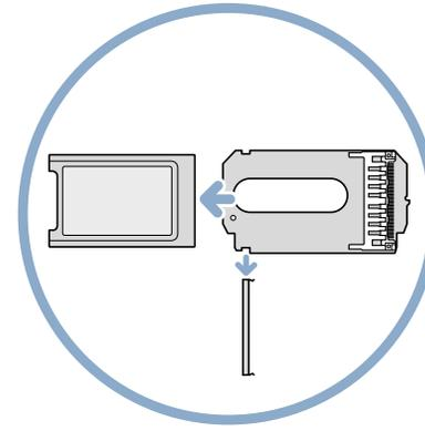
**3** Le cas échéant, retirez l'attache métallique et sortez la carte AirPort de l'adaptateur. Ce dernier est inutile avec l'iBook.
