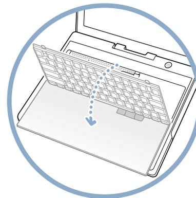
**3** Soulevez le clavier et posez-le sur le repose-poignets et le trackpad en le retournant. Touchez un composant métallique à l'intérieur de l'ordinateur.
