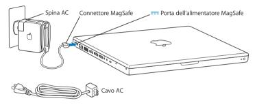
Per estendere la lunghezza dell'alimentatore, scollega la spina AC per rimuoverla dall'alimentatore. Collega il cavo AC incluso, verificandone il corretto posizionamento. Inserisci l'altra estremità nella presa a muro. Il cavo AC è dotato di messa a terra.
