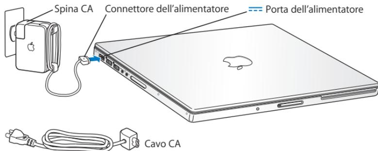
Per utilizzare l'alimentatore da una distanza superiore, si può usare il cavo CA. Tirare la spina CA verso l'alto per rimuoverla dall'alimentatore e collegare il cavo CA incluso. Inserire l'altra estremità nella presa a muro. Per un'illustrazione, vedere pagina 34.
