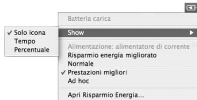
Il livello di carica visualizzato indica la quantità di carica rimanente con le applicazioni, le periferiche e le impostazioni di sistema (luminosità dello schermo, impostazioni per il risparmio energia e altro ancora) attualmente in uso. Per aumentare la potenza della batteria, chiudere le applicazioni e scollegare le periferiche inutilizzate, quindi regolare le impostazioni per il risparmio energia (consultare la sezione successiva).
