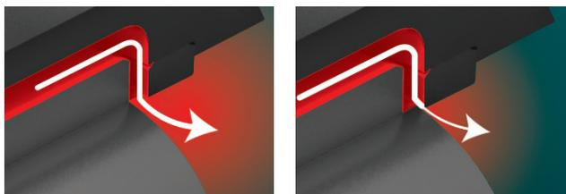
*L'orifice variable s'ouvre et se ferme pour contrôler dynamiquement la pression de la chambre de compensation.*
