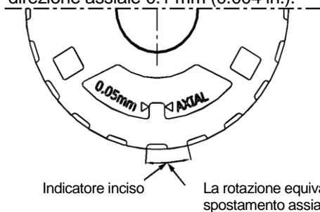
*Esempio:* per la registrazione del gioco necessario di una girante di 0.4 mm (0.016 in.) spostare il portacuscinetto [3240] in senso antiorario di quattro indicatori.
