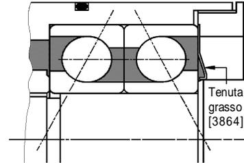
La tenuta grasso (tipo con gioco) viene montata solo sulle unità con opzione di lubrificazione a grasso.
