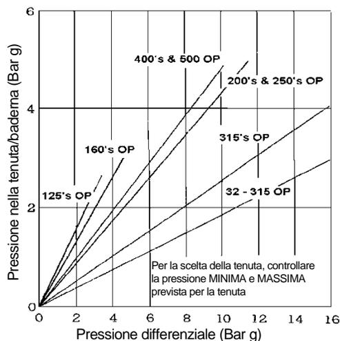
Pressione sul retro girante generata sulle giranti ad alettatura inversa (RV):
