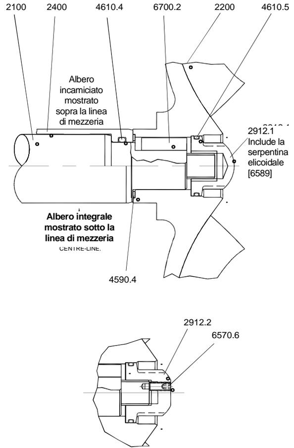
Design con trascinamento a mezzo chiavetta per acciaio inossidabile 304/316 e superiore; fissare le vite con sigillante a base PTFE (Loctite 577)
