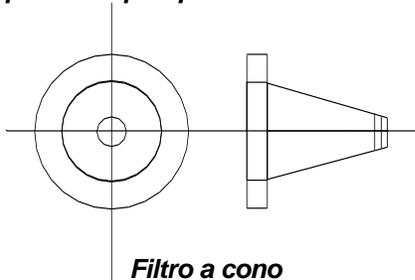
Flowserve consiglia che i filtri di aspirazione siano composti da una lamiera d'acciaio conica. La lamiera deve avere fori da 1.6 mm ( $1/16$  in.) ed essere di dimensioni e spessore appropriati per il flusso richiesto. Si osservi la figura sopra.
