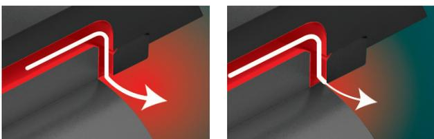
*L'orificio variabile si apre e si chiude per controllare dinamicamente la pressione della camera di bilanciamento.*
