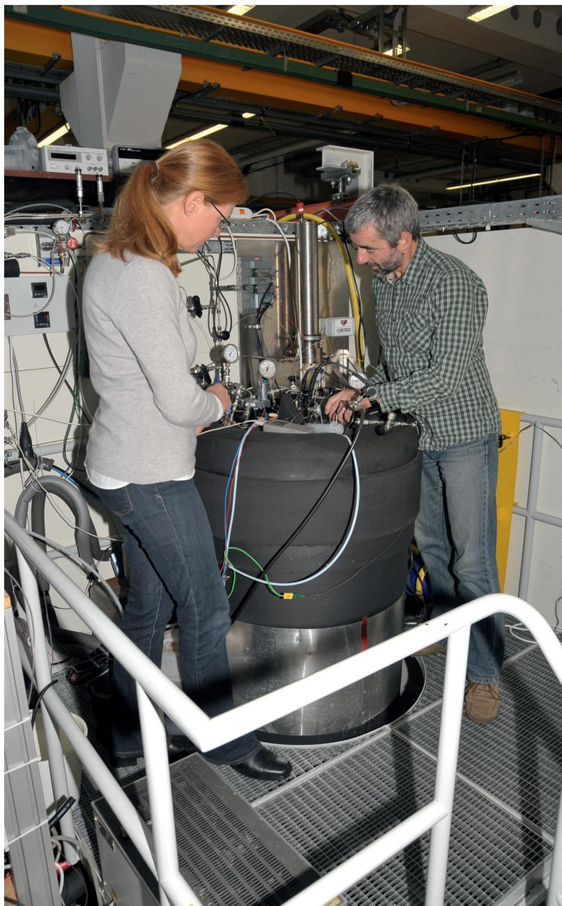
Abb. 6: Der großvolumige Reservoirsimulator kann bis zu einem Druck von 250 bar und Temperaturen über  $-10^{\circ}\text{C}$  betrieben werden. Diverse Pumpen sorgen für den Aufbau des Poren- und Umgebungsdrucks. Hier können Gashydrate in Sedimenten unter realitätsnahen Bedingungen erzeugt und Abbaumethoden getestet werden.
