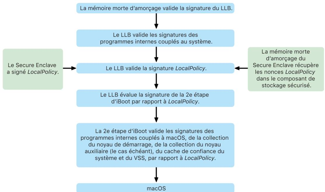
Lors de la première étape de la chaîne de confiance, la puce exécute du code à partir de la mémoire morte d'amorçage. Le démarrage sécurisé de macOS sur un Mac avec puce Apple vérifie le code du système d'exploitation même ainsi que les règlements de sécurité et les extensions de noyau (ces dernières sont prises en charge, mais leur utilisation n'est pas recommandée) configurées par les utilisateurs autorisés.
