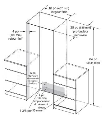
\*Un retour fini d'au moins 4 po (102 mm) qui correspond à l'extérieur de l'armoire est recommandé sur tous les côtés et le haut de l'ouverture de découpe. La zone ombragée sera visible après l'installation.
