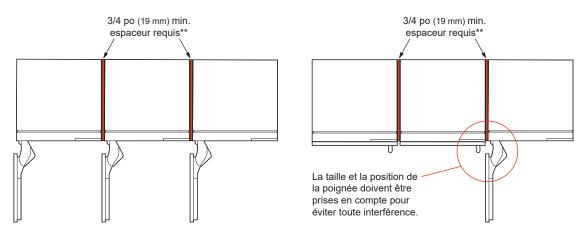
\*\*Lorsque vous utilisez l'ensemble de panneaux de porte en acier inoxydable ou des panneaux personnalisés de 3/4 po (19 mm) avec notre poignée en aluminium brossé (offerte en option), un espaceur minimum de 3/4 po (19 mm) entre les unités est nécessaire pour ouvrir chaque porte à 90° sans interférence.
