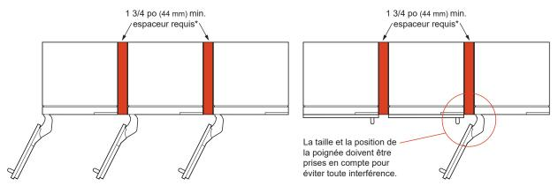
\*Lorsque vous utilisez l'ensemble de panneaux de porte en acier inoxydable ou des panneaux personnalisés de 3/4 po (19 mm) avec notre poignée en aluminium brossé (offerte en option), un espacement minimum de 1 3/4 po (44 mm) entre les unités est nécessaire pour ouvrir chaque porte à 115° sans interférence.
