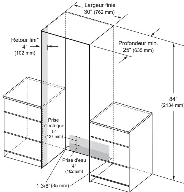
\* Un retour fini d'au moins 4 po (102 mm) correspondant à l'extérieur de l'armoire est recommandé sur tous les côtés et le haut de l'ouverture de découpe. La zone ombragée sera visible après l'installation.
