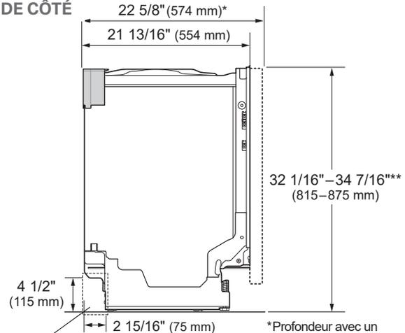
Le tuyau d'alimentation d'eau, le tuyau de vidange et le câble électrique doivent passer dans cette zone.
