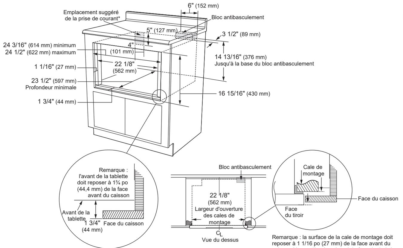
\* Peut aussi être installé en utilisant une prise de courant placée dans une armoire adjacente si le câble est assez long. L'ouverture pour faire passer le câble dans l'armoire doit avoir un diamètre minimum de 1 1/2 po (38 mm) et ne porter aucune arête dommageable.
