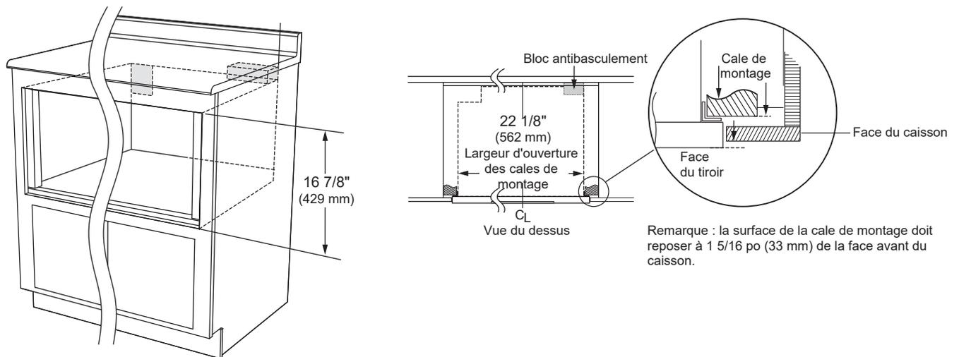
Remarque : la surface de la cale de montage doit reposer à  $1 \frac{5}{16}$  po (33 mm) de la face avant du caisson.
