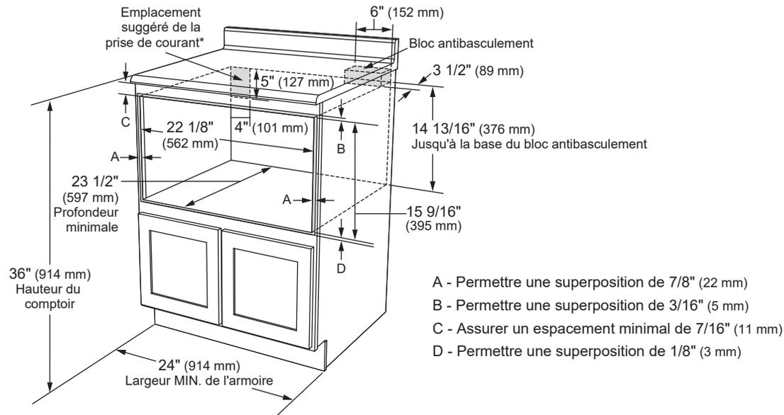
\* Peut aussi être installé en utilisant une prise de courant placée dans une armoire adjacente si le câble est assez long. L'ouverture pour faire passer le câble dans l'armoire doit avoir un diamètre minimum de 1/2 po (38 mm) et ne comporter aucune arête dommageable
