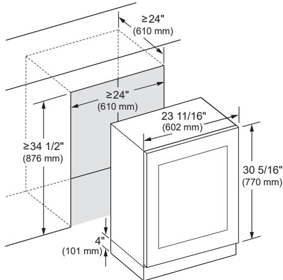
\* Une longueur finie d'un minimum de 4" (101 mm) sur la paroi intérieure de l'ouverture de la même couleur que la finition extérieure est recommandée sur chaque côté. La zone grisée sera visible après l'installation.
