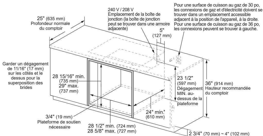
\*25" (635 mm) : profondeur MIN. de l'ouverture pour une installation affleurante sous le comptoir.
