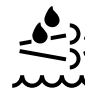
Illustration 1 : Témoin de niveau de liquide d'échappement diesel (DEF) sur le tableau de bord
