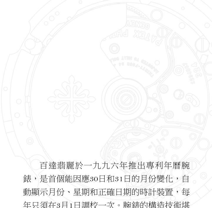
百達翡麗於一九九六年推出專利年曆腕錶，是首個能因應30日和31日的月份變化，自動顯示月份、星期和正確日期的時計裝置，每年只須在3月1日調校一次。腕錶的構造技術堪稱令人嘆為觀止的挑戰。為求儘量減少傳統上於萬年曆裝置使用的搖臂和槓桿數目，百達翡麗工程師設計出一種主要依賴齒輪和十瓣齒輪的結構。因此，324 S QA LU 24H機芯由347枚部件組成，而26-330 S QA LU機芯則由339枚部件組成；相對之下，配備月相顯示的傳統萬年曆裝置部件總數僅約280枚。年曆顯示配搭24小時顯示盤，相得益彰。此外，專利年曆腕錶更配以月相顯示，高度準確，每122年才會與真正的月亮運行週期出現一天的偏差。
