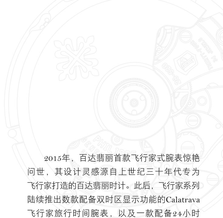
2015年，百达翡丽首款飞行家式腕表惊艳问世，其设计灵感源自上世纪三十年代专为飞行家打造的百达翡丽时计。此后，飞行家系列陆续推出数款配备双时区显示功能的Calatrava飞行家旅行时间腕表，以及一款配备24小时闹钟装置的超级复杂功能系列旅行时间闹钟腕表。首款飞行家计时腕表Ref. 5924搭载CH 28-520 C FUS自动上弦机芯，融合三项易于操作的实用复杂功能：飞返计时、旅行时间显示以及与当地时间同步的指针式日期显示（12时位置）。为延续简约的设计风格，常设于表壳侧边8时和10时位置的两枚当地时间调校按钮被同位置的大号调校按钮所取代，可使用随表款附赠的专属调试笔进行激活。CH 28-520 C FUS机芯沿用经典导柱轮设计，可精确传输计时指令。这款机芯以碟形垂直离合器取代了传统的齿轮啮合水平离合器。这一现代技术方案可将磨损降至最低，近乎于无；中心计时秒针还可用作连续秒针。飞返功能可瞬间启动新计时，而无需先暂停指针。
