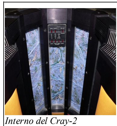
Il Cray-2. Dentro il cilindro si trovano le CPU e il liquido di raffreddamento. A lato gli hard disk
