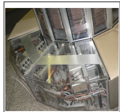
Particolare del sistema di raffreddamento
