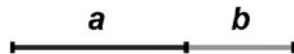
Abb. 13: Teilung einer Strecke im Verhältnis des goldenen Schnittes: a verhält sich zu b wie a+b zu a .
