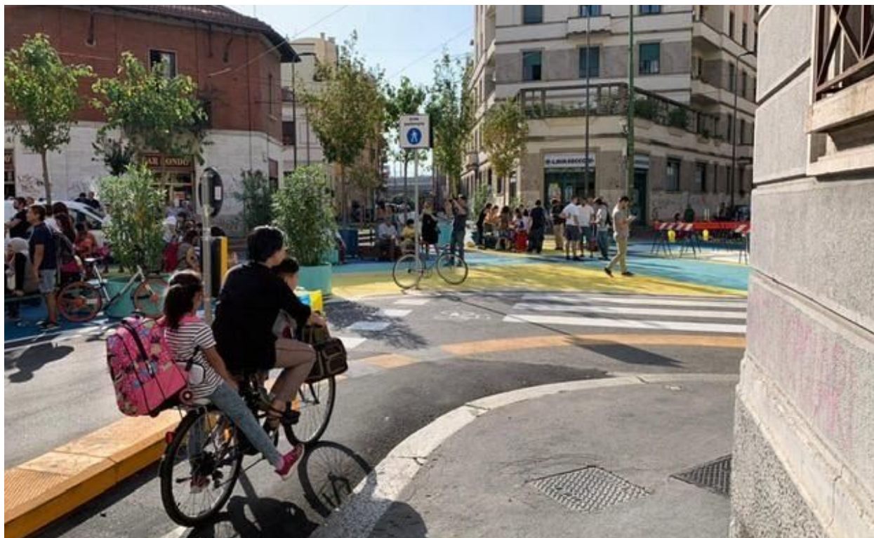
Milano, Piazze Aperte. Pista ciclabile contromano protetta da cordoli in Via Martiri Oscuri.
